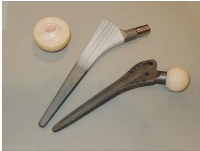
Abbildung 10. Calciumphosphate in der Hüftendoprothetik: Ein keramisches Kugelgelenk ( $\text{Al}_2\text{O}_3$ ), eine calciumphosphatbeschichtete Endoprothese (zementfreie Endoprothese) und eine unbeschichtete Endoprothese, die im Femurschaft mit PMMA-Knochenzement fixiert wird. PMMA = Poly(methylmethacrylat).
